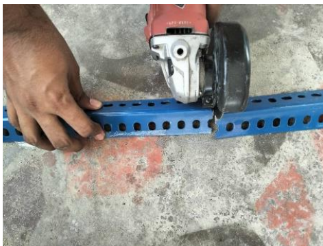
Rajah 3: Proses pemotongan besi
