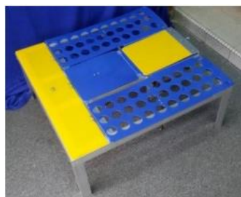
Rajah 3 : Mesin Pelipat Baju Manual
