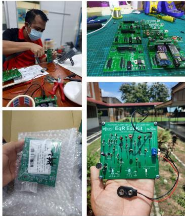
Rajah 6: Proses pengujian PCB bagi EqR Edukit dan Mobile E-Meter
