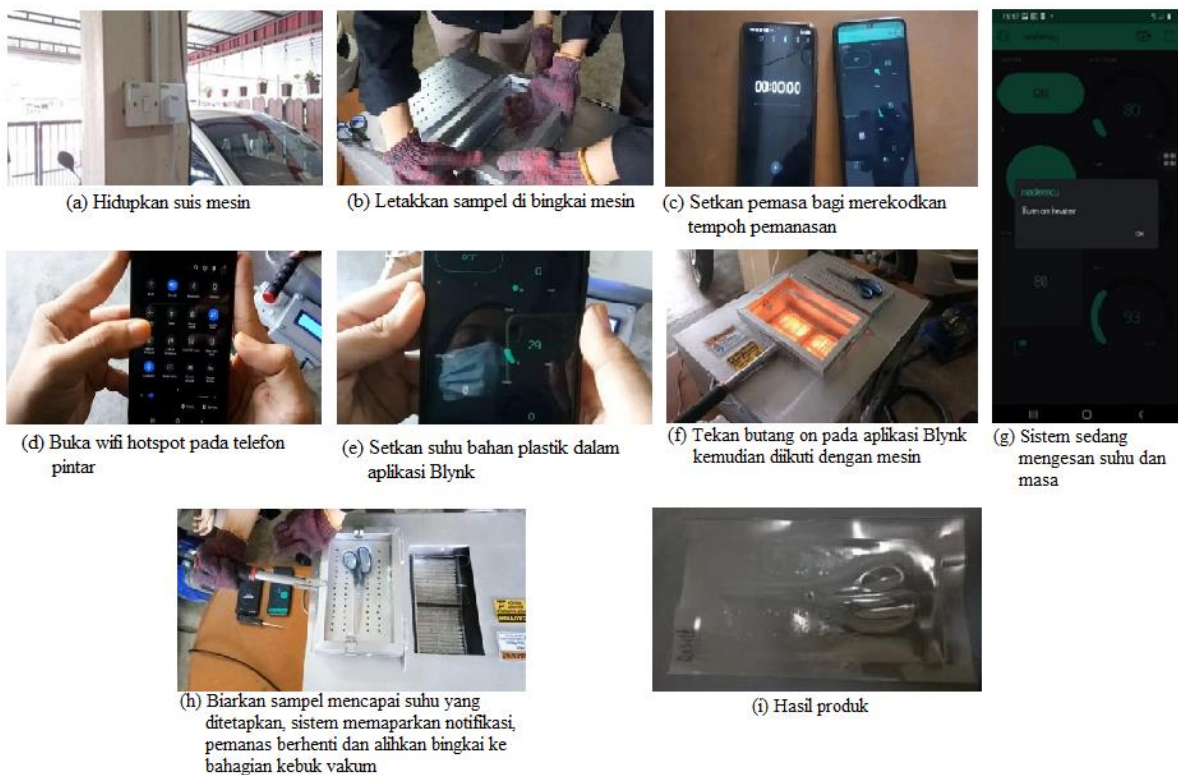
Rajah 9 Prosedur pengendalian mesin dan sistem kawala
