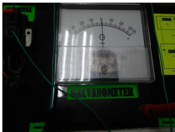
Rajah 8: Galvanometer sebagai penunjuk null
